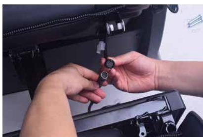
Voici à quoi ressemblent les connecteurs à huit broches.
