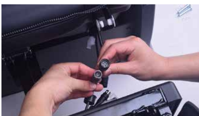
Voici à quoi ressemblent les connecteurs à quatre broches.
